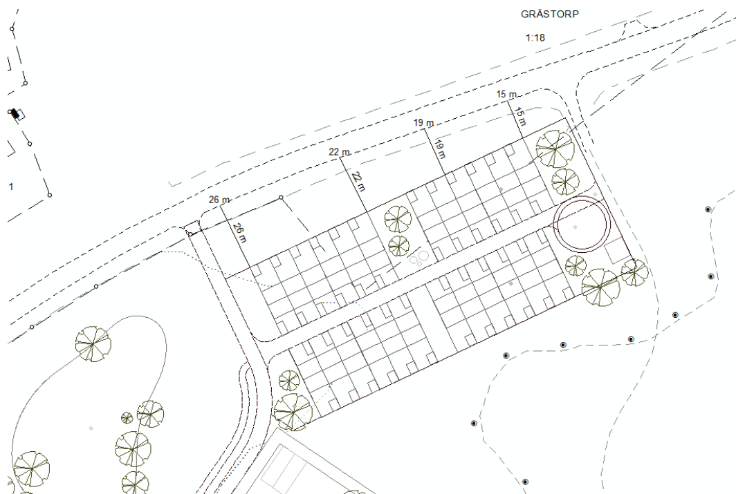
Figur 4-3. Bild som visar avstånd mellan tomtgräns till ny bostadsbebyggelse och väggkant till väg 186.
