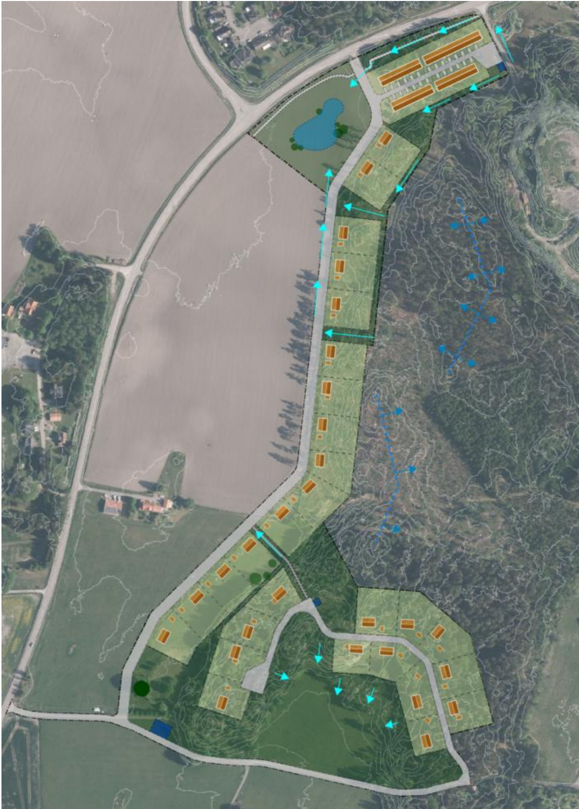
Figur 6 - Illustrationsplan över den tänkta bebyggelsen med plats för tre skyfallsvägar mellan bebyggelsen, var av en även möjliggör en gångväg. Liljevall arkitekter, 2024.
